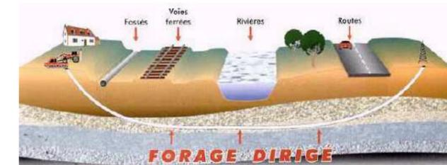
Figure 164 : Exemple de forage dirigé (Source : Contant.fr)
